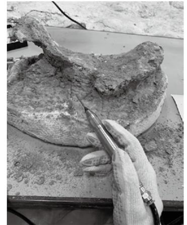
【写真1】愛用したエアスクレイパー。先端の針が高速で振動しており、簡単に岩石を削ることができる。
